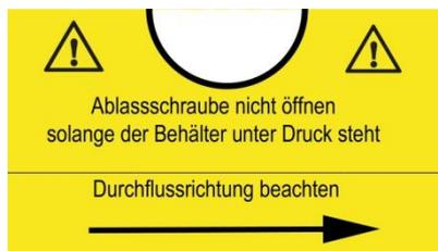
Vorsicht: Die Ablassschraube (8) darf nicht geöffnet werden solange der Behälter bzw. die Anlage unter Druck steht.
